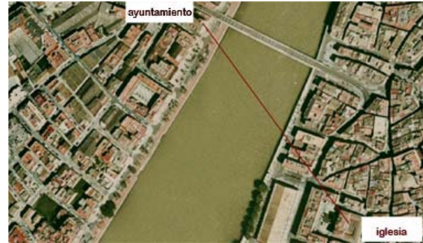
Enlace entre dos sedes municipales mediante WiMax
