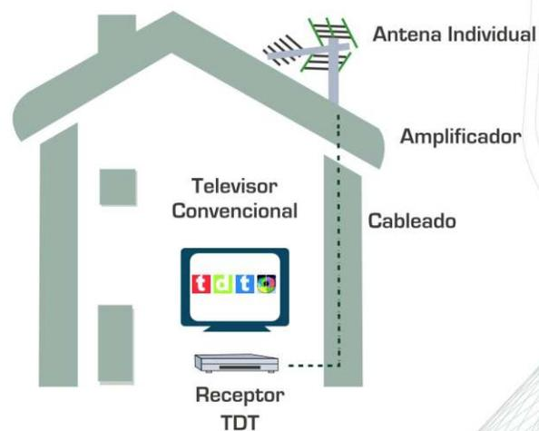
Fig. 16: Ejemplo de Instalación de la TDT en vivienda individual
