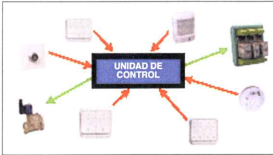
Figura 2. Configuración de un sistema domótico centralizado.
