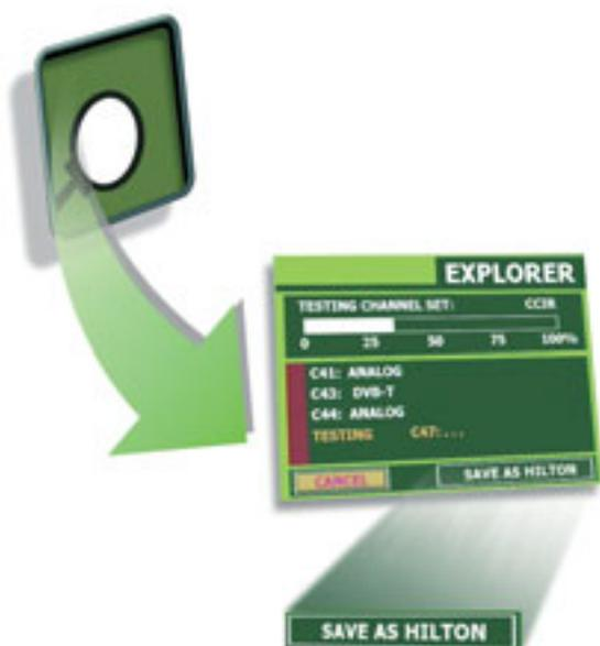
Quando se pulsa la tecla del "**explorador**" durante unos segundos, se inicia una nueva sesión de exploración. A diferencia de otros medidores, el **EXPLORER** realiza una exploración dinámica del espectro, detectando todos los canales en la banda de barrido. Esto se aplica a las bandas de TV terrestre y satélite.
