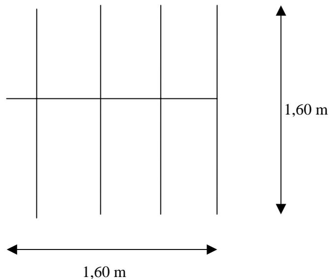
Figura 3. Antena de 4 dipolos con varillas de 6 mm
